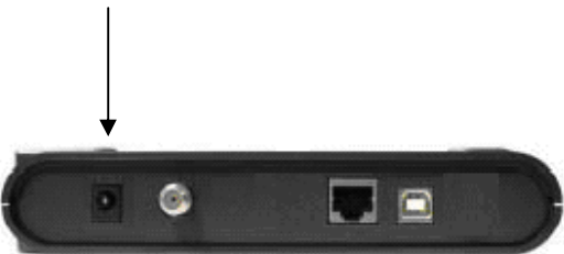
Şekil 2. AC Adaptör'e güç bağlantısı
